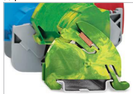
Держатель включает розетку с фиксирующим устройством для сборной шины 10 x 3 мм. Контакт между сборной шиной и рейкой устанавливается автоматически после установки ее на защелку на несущую рейку. Один конец шины устанавливается на держатель шины с заземлением, второй вставляется в среднюю часть изолированного держателя шины.
