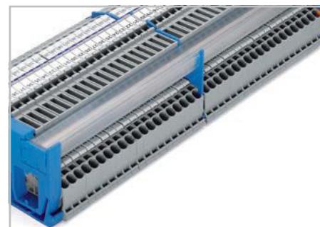
Компактные держатели распределительной шины, расположенные через каждые 200 мм, обеспечивают дополнительную поддержку шины при протяженном монтаже.
