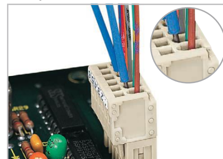
Тестирование при помощи тестового штекера Ø 1 мм (735-500) – точный контакт.
