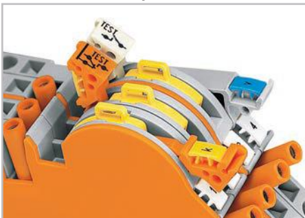
Блокираторы включения устанавливаются с щелчком в одну из двух промаркированных позиций, предотвращая случайное включение разомкнутой линии.
