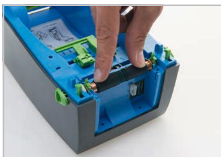
Вставьте и зафиксируйте подходящий валик в принтере.
